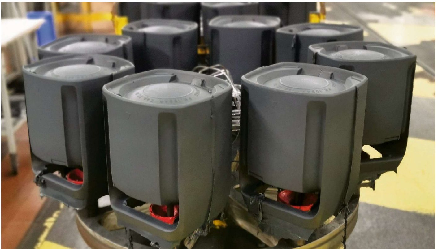
Le groupe industriel eurélien Raigi SA produit des élastomères et fabrique des pièces telles que le réservoir GPL Le Cube dans ses locaux sur la petite commune de Rouvray-Saint-Denis, près du département loirétain.
